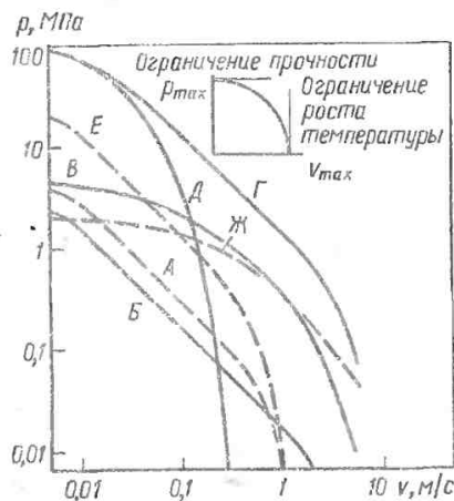
Рис. 4.73. Допустимые давления и скорости для втулок из материалов для работы при сухом трении [4.100]:
