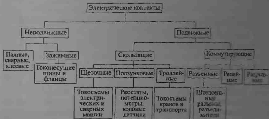
Рис. 12.17. Классификация электрических контактов
