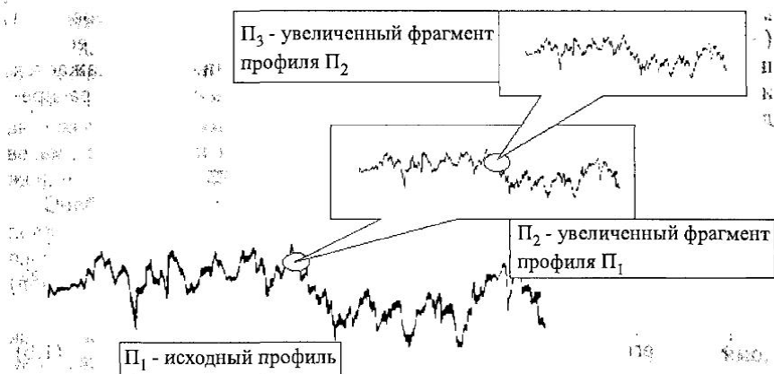
Рис. 1.12. Фрактальность шероховатости реальной поверхности
