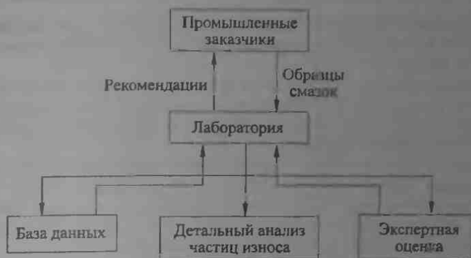
Рис. 8.19. Структура центра диагностики машин
