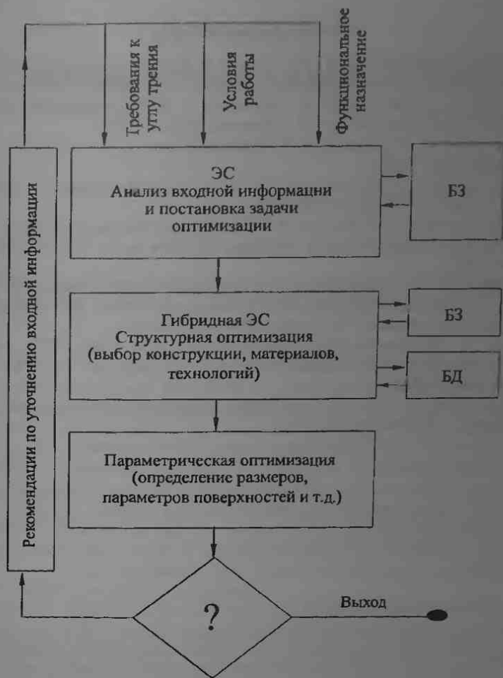
Рис. 8.21. Схема синтеза узла трения (Евельсон и др. Трение и износ. 2000 Т. 20, № 4. С. 380-385)
