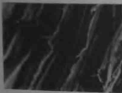
Рис. 6.5. Поверхность после изнашивания закрепленным абразивом, на которой видны канавки
