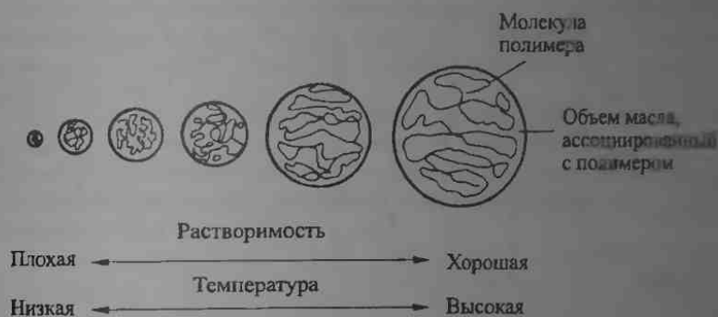
Рис. 10.9. Добавки, повышающие вязкость, и механизм загущения
