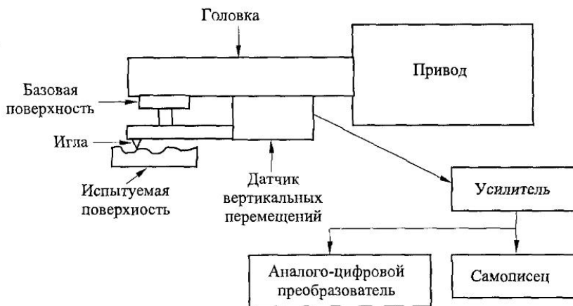
Рис. 1.19. Схема щупового профилометра
