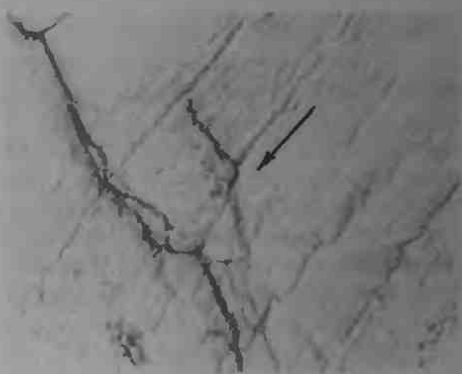
Рис. 6.8. Трещины усталости на поверхности трения (стрелкой показано направление скольжения)
