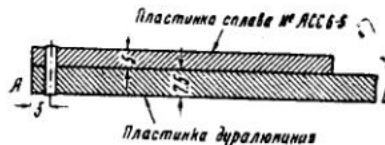
Рис. 3. Пакет, подготовленный к прокату. Пакет составлен из пластинки сплава АСС-6-5 и пластинки дуралюминия
