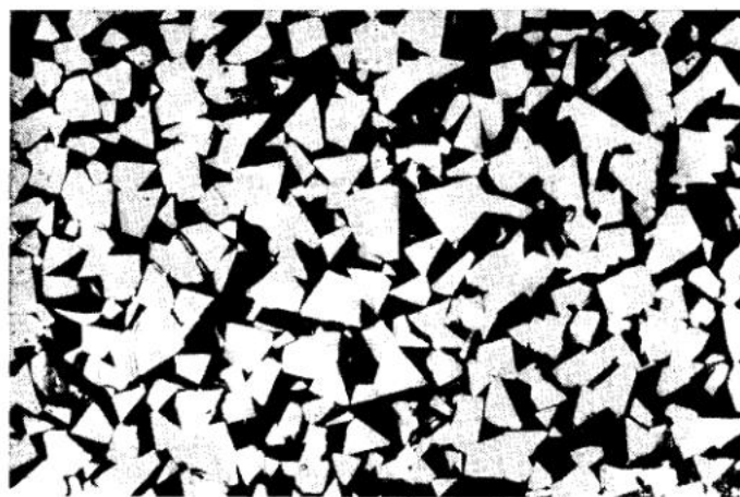
Рис. 10. Микрофотография окисленной в печи поверхности образца никеля
