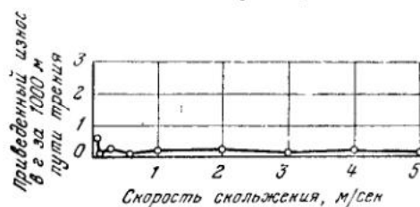
Рис. 3. Изменение величины износа в зависимости от скорости скольжения при сухом трении олова по Ст. 45 в воздушной среде.
