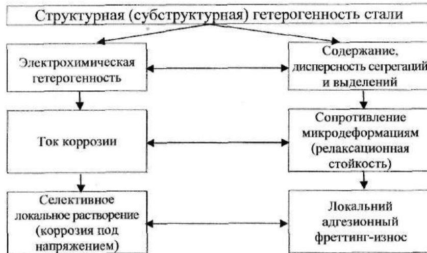
Рис. 3.32. Схема влияния структурной гетерогенности стали на показатели электрохимической активности, микропластичность и фреттинг-процесс
