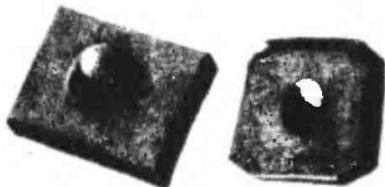
Рис. 3.11. Шаровой индентор и пластина, изготовленные из свинца, после сжатия
