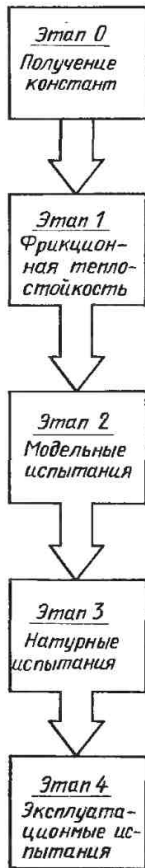
Рис. 7.10. Рациональный цикл последовательных испытаний для тормоза скоростного поезда «Русская тройка» для фрикционных материалов, работающих в паре с чугуном СЧ 21-40:
