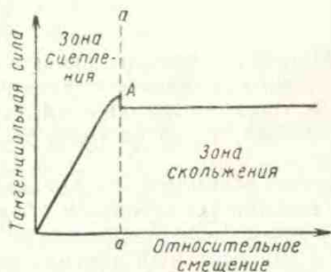
Рис. 56. Принципиальный вид зависимости величины предварительного смещения от тангенциальной силы
