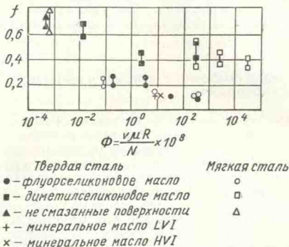
Рис. 171. Зависимость коэффициента трения от безразмерного параметра \Phi при скольжении индентора из мягкой и твердой стали по мягкой стали
