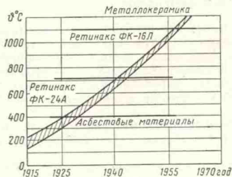
Рис. 232. Тенденция роста требований по теплостойкости тормозных материалов
