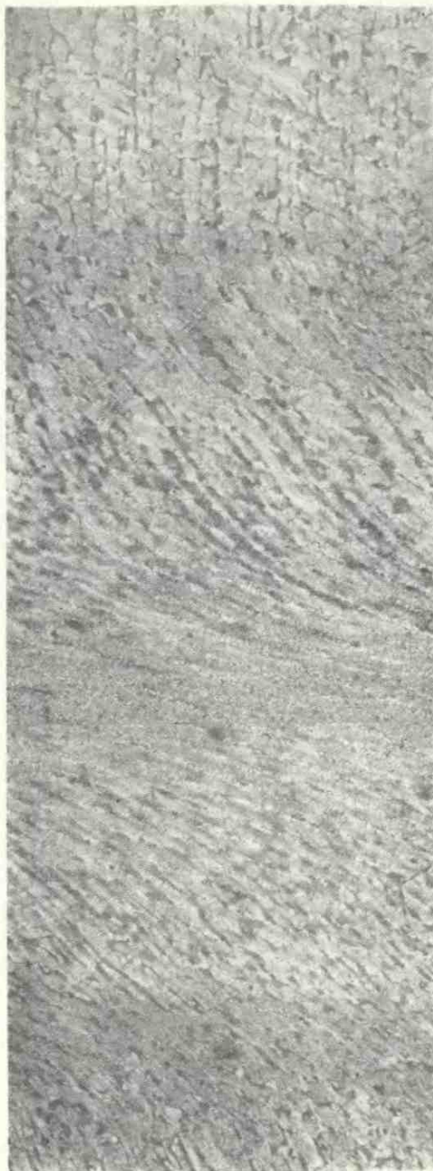
Рис. 84. Микроструктура сварного соединения (В. И. Вилль). \times 70
