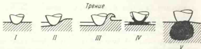
Рис. 18 Основные виды нарушения фрикционных связей
