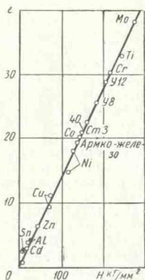
Рис. 94. Зависимость между относительной износостойкостью и твердостью чистых металлов (по Хрущову и Бабичеву)
