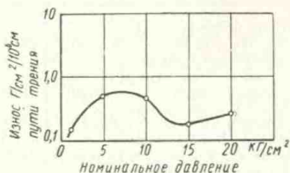
Рис. 98. Износ несмазанных металлов в зависимости от давления
