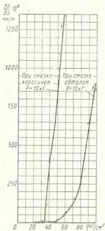
Рис. 66. Диаграмма темпа линейного износа в зависимости от удельного давления для чугуна
