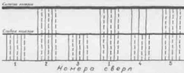
Рис. 118. Когезия быстрорежущей стали Р18 и титановому сплаву ОТ4 при различных состояниях цепи термотока (— замыкнута, --- разомкнута) и режимах резания: 1, 2, 3— v=8 м/мин, s=0,12 мм/об, 4, 5— v=10,5 м/мин, s=0,20 мм/об (диаметр сверл 11 мм; обработка стружкой).
