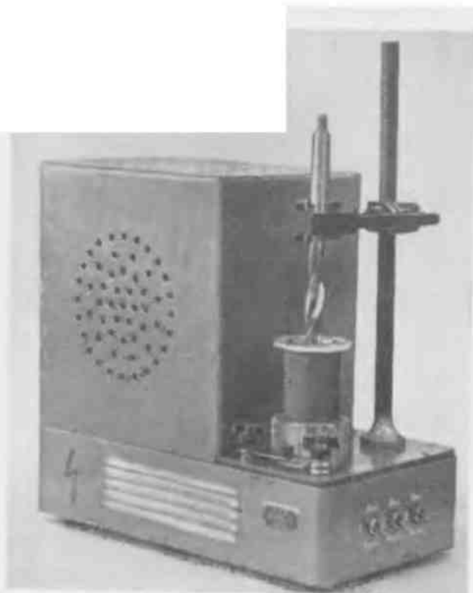
Рис. 126. Опытный образец установки для магнитной обработки инструмента (УМО-1)
