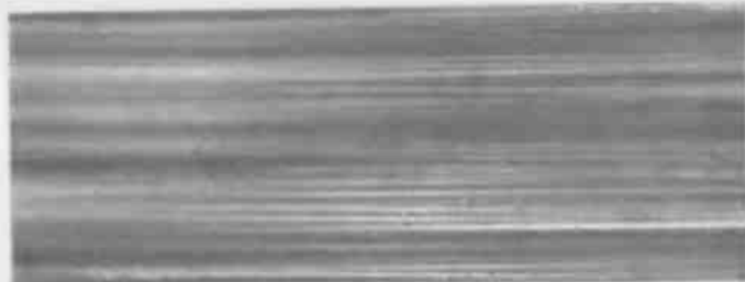
Рис. 55. Полосы скольжения на оплавленной поверхности меди, образованные выступами шероховатости полибелового индентора. \times 200
