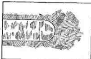
Рис. 83. Схема формирования рельефа при трении скольжения системы шар — плоскость.
