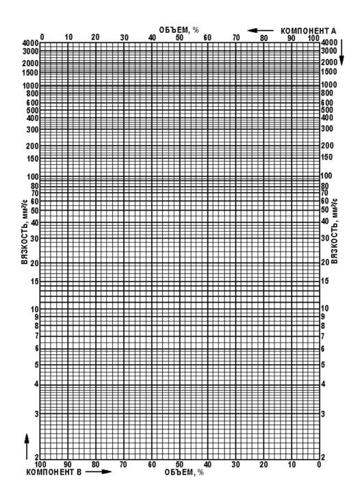
Для ориентировочного определения вязкости смеси двух масел при одинаковой температуре необходимо:
